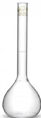
**Задача 1.** Проверьте объем мерной колбы вместимостью 25 мл методом взвешивания с учетом температуры и атмосферного давления (значение давления можно взять из прогноза Гидрометцентра), используя следующую формулу:
