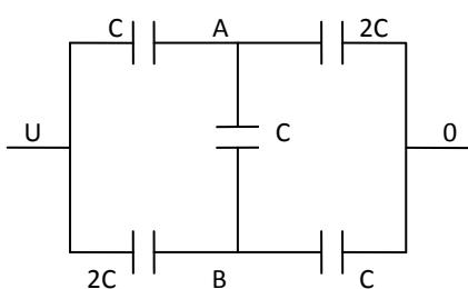
Представленную на рисунке цепь из конденсаторов подсоединили к источнику постоянного напряжения  $U=10$  В. Наименьшая из представленных емкостей равна  $C=20 \text{ мкФ}$ . Найдите разность потенциалов между точками  $A$  и  $B$ . Определите также эквивалентную ёмкость всей цепочки.
