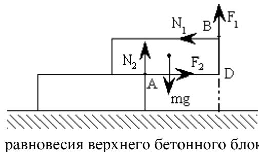
Когда верхний бетонный блок начинает падать, то он поворачивается вокруг оси, совпадающей с верхним, ближним к стенке, ребром неподвижного бетонного блока  $A$ , поэтому действующие на него силы реакции и трения будут приложены в местах положения верхних, ближних к стенке, ребер подвижного и неподвижного блоков  $A$  и  $B$ . Учитывая это, записываем условия равновесия верхнего бетонного блока:
