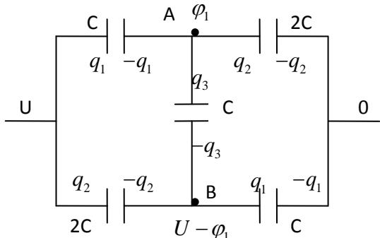
Используя симметрию схемы, указываем значения зарядов на пластинах конденсаторов и выражаем их через потенциалы в узлах
